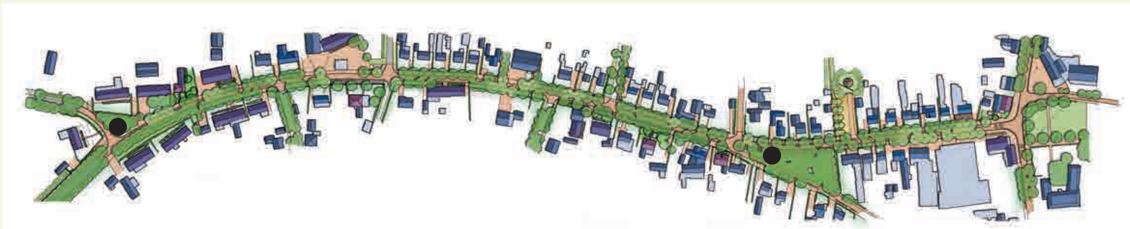
▲ Schets voor de inrichting van de Wilhelminalaan in Vessem. Hierin zijn twee putten opgenomen die als infiltratiepunten dienen. Bron: Beeldkwaliteitsplan gemeente Eersel.
