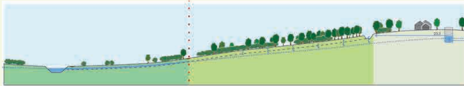
▲ De doorsnede laat zien waar water kan inzijgen (infiltreren) (licht groene deel) en als kwel weer kan opkomen (donder groene deel).
